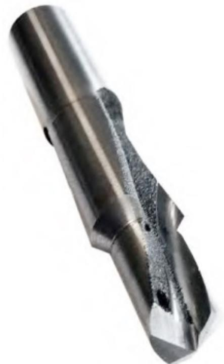
Ein Werkzeug aus dem „PräziGen“-Projekt, bei dem Vollhartmetall-Sonderwerkzeuge mit den geometrischen Freiheitsgraden der additiven Fertigung konstruiert, additiv aufgebaut, geschliffen, beschichtet und getestet wurden
