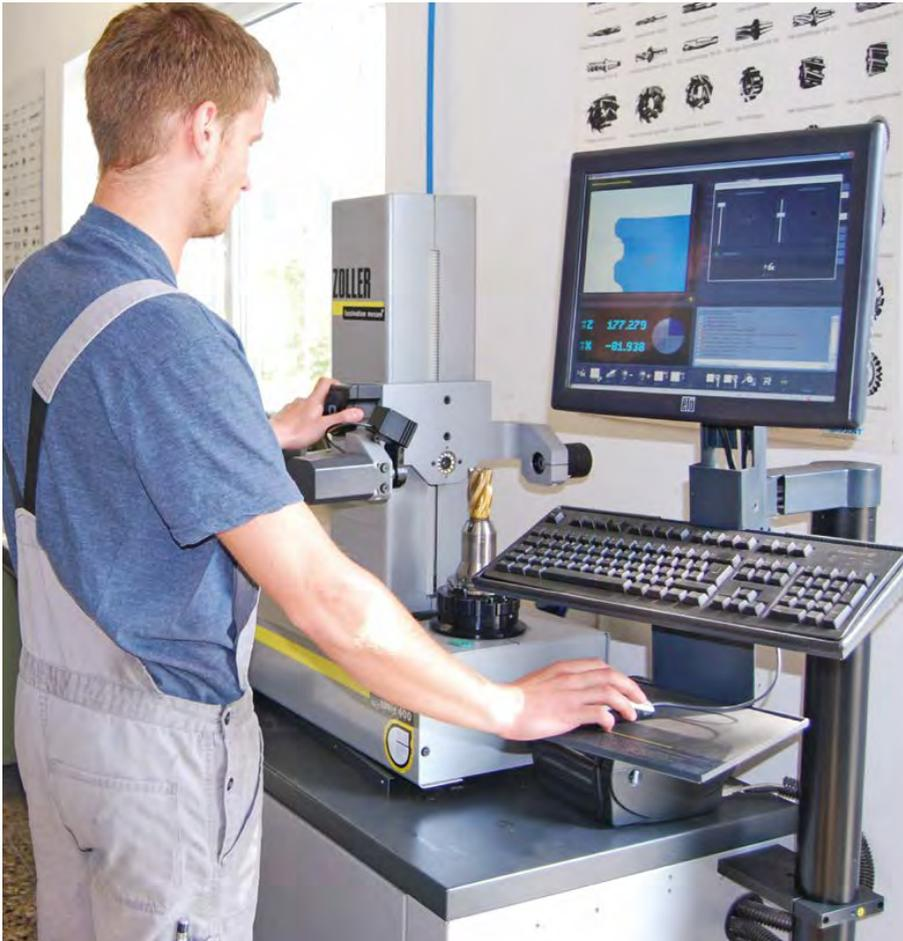
Schneidwerkzeugmechaniker beim Vermessen eines Sonderwerkzeugs.
